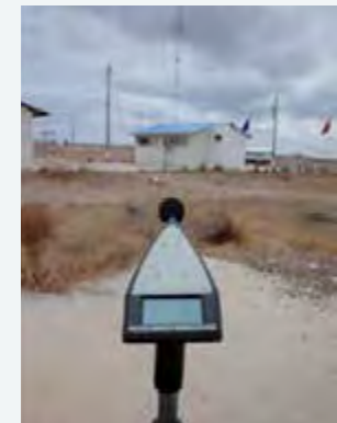
Figure 03: Sonometer used and noise measurement table at site / Source: Environmental Impact Assessment, 81. Figura 03: Sonómetro utilizado y tabla de medición de ruido en el sitio / Fuente: Evaluación de Impacto Ambiental, 81.
