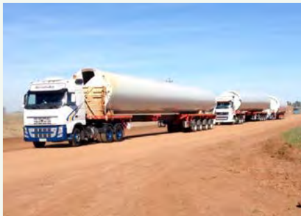
Figure 10: Trucks transporting the prefabricated towers to the site during construction process / Source: Picture taken during on-site visit, May 2013. Figura 10: Los camiones utilizan vías de acceso mejoradas / Fuente: Fotografía tomada durante la visita al sitio en Mayo 2013
