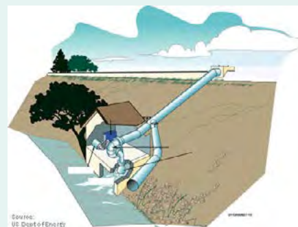
Figure 02: “Central hidroeléctrica de pasada” / Source: Besalco S.A., US department of energy. Figura 02: “Central hidroeléctrica de pasada” / Fuente: Besalco S.A.; Departamento de Energía, Estados Unidos.
